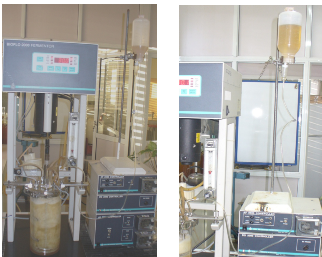
FIGURA 1. Equipo de acetificación en sistema semicontinuo de escala laboratorio.
