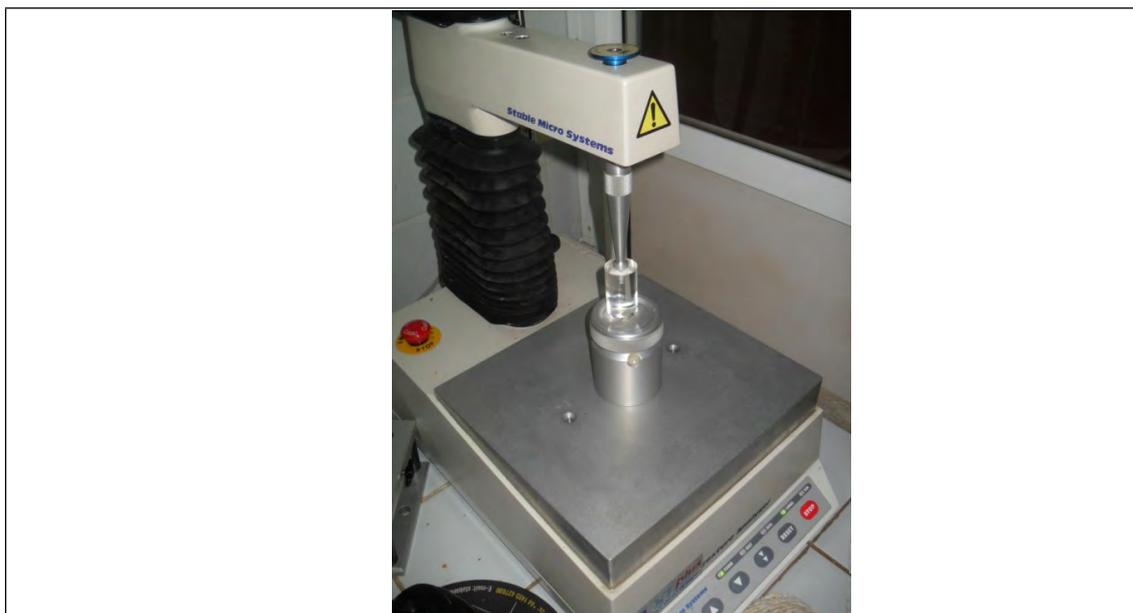
**Fotografía N° 1.** Equipamiento utilizado en la determinación de la adhesividad, cohesividad y pegajosidad de masas crudas.
