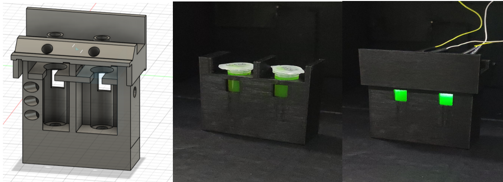
Figura 8: Diseño e implementación de la nueva gradilla experimental. Izquierda: vista posterior del modelo de la gradilla en Autodesk Fusion 360. Centro: vista anterior de la gradilla sin capuchón impresa en PLA negro con dos tubos de reacción. Derecha: gradilla impresa con capuchón y LEDs azules encendidos.
