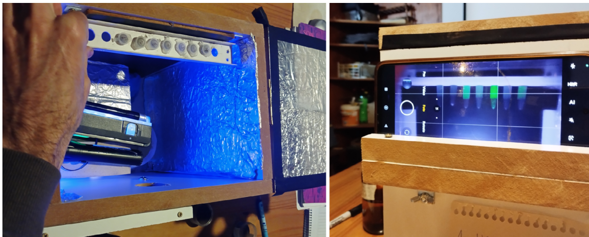
Figura 4: Sistema experimental y validación de la metodología en campo. Izquierda: Interior de la caja oscura en la que se observa la gradilla con los tubos de reacción desmontable y la fuente de luz UV. Derecha: exterior de la caja oscura dónde se dispone un teléfono celular que registra imágenes de las reacciones enzimáticas en el interior de la caja.
