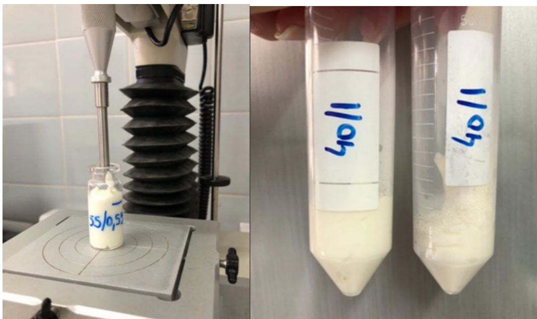
Figura 3. Pruebas llevadas a cabo en los hidrogeles: a) Ensayo de textura (firmeza de gel) y b) Sinéresis.
