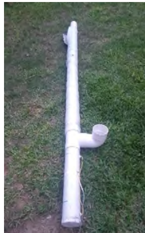
Figura 5. Vista del tubo vertical de depósito de agua y salida de aire climatizado.
