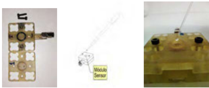
Fig. 3. Foto del módulo sensor con el piezoeléctrico montado. Impreso en MSLA con resina translúcida.
