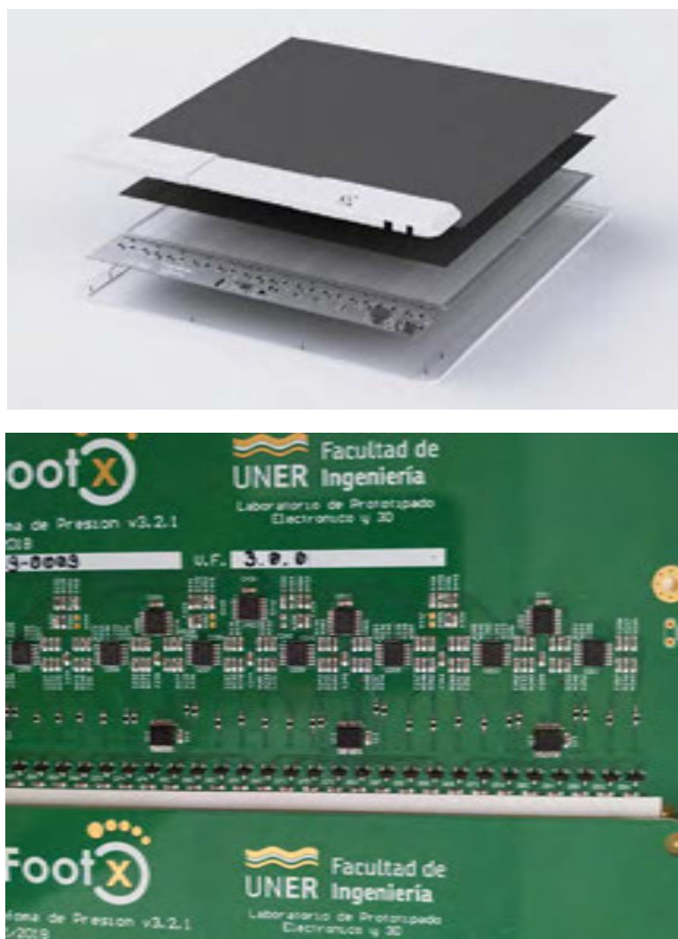
Fig.7. Arriba: Despiece del prototipo de Plataforma de Baropodometría. Abajo: Detalle de la placa principal con el logo de UNER Facultad de Ingeniería.
