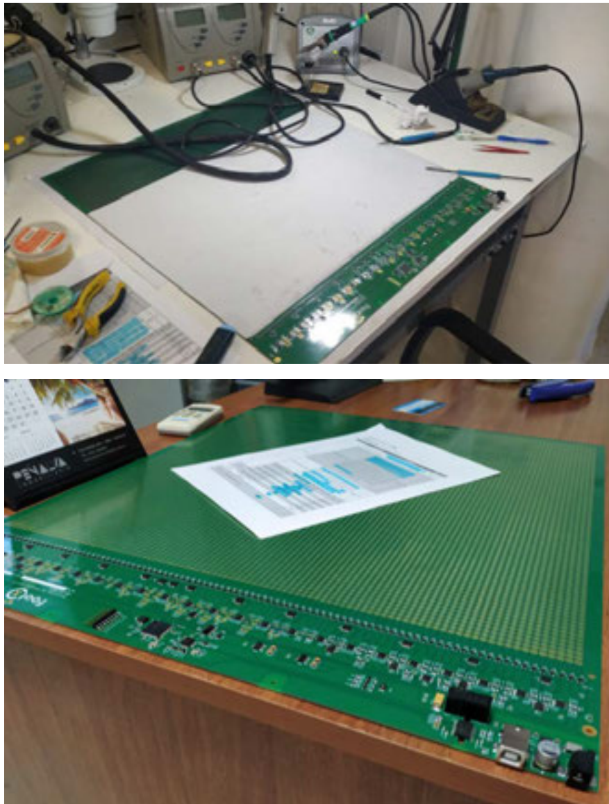
Fig.8. Arriba: Detalle del montaje del módulo de sensado del equipo. Abajo.: Imagen de la placa principal con los componentes electrónicos montados.
