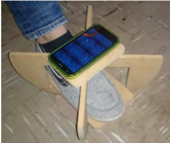
**Figura 7:** El Smartphone montado en la Base Podal mide la inclinación que tiene el tobillo, a partir del acelerómetro incorporado
