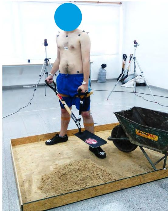
**Figura 9:** Montaje de los materiales para el registro del gesto de paleo en el laboratorio.
