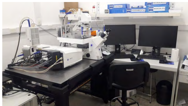
Figura 4: Microscopio laser confocal LSM880 (Carls Zeiss) ubicado en el Laboratorio de Microscopía Aplicada a Estudios Moleculares y Celulares (LMAE)
